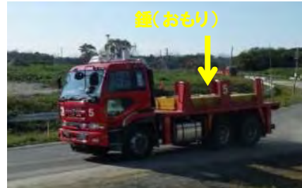
大型車両を走行させ舗装への影響を確認
