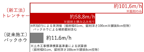
図-4 施工速度の比較 (駐車帯部)
